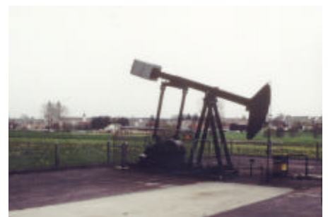
Erdölpumpe bei Rot an der Rot, Förderung organischer Ablagerungen aus warmen Erdzeiten (Mesozoikum)
